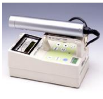
シンチレーション式サーベイメータ
